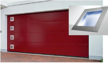
Hublot «triple vitrage» avec sécurité renforcée grâce au verre feuilleté intérieur/extérieur 33<sup>2</sup>/12/4/12/33<sup>2</sup>. Le triple vitrage est disponible en vitrage clair, Delta mat, granité 200 et sablé.
