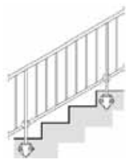
Barreaudage sous main courante
