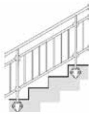
Barreaudage sous lisse supérieure
